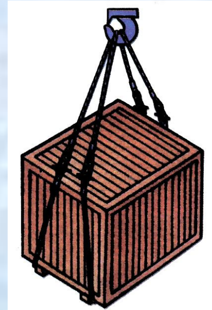
СТРОПУВАННЯ ДВОМА ДВОПЕТЛЬОВИМИ СТРОПАМИ УСТАТКУВАННЯ В ДЕРЕВ'ЯНІЙ ТАРІ
