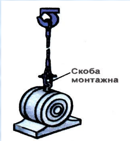
СТРОПУВАННЯ ЕЛЕКТРОДВИГУНА ДВОПЕТЛЬОВИМ СТРОПОМ
