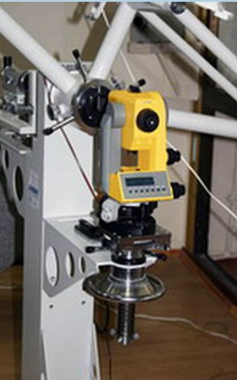
Автоколімаційна установка для перевірки нівелірів і теодолітів АУПНТ
