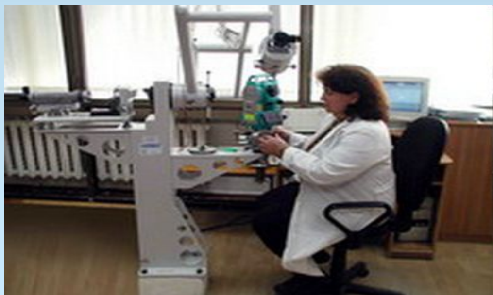
Автоколімаційна установка для перевірки нівелірів і теодолітів АУПНТ
