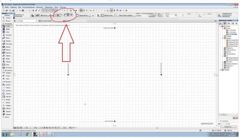
Настроить инструмент стена, задав его размеры, цвет, высоту относительно нуля можно здесь.
