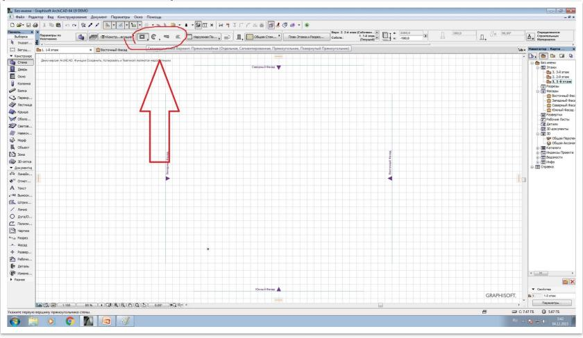
Если зажать кнопку мыши на одном из этих геометрических вариантов, у которого есть снизу треугольник, то можно выбрать дополнительный их вид.
