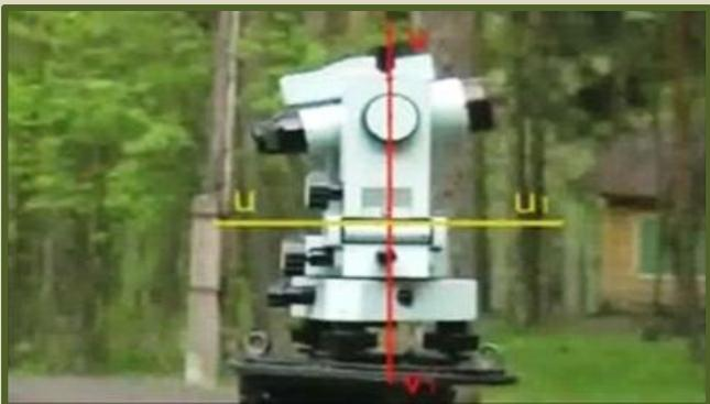
**1-ая поверка.** Проверяется выполнение условия: ось цилиндрического уровня при алидаде горизонтального круга должна быть перпендикулярна оси вращения теодолита.
