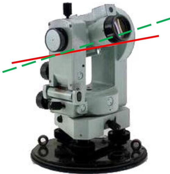
Если  $c > 1'$ , выполняют исправление. Вычисляют правильный отсчет:  $Л - c$  (при КЛ) или  $П + c$  (при КП). Устанавливают правильный отсчет по горизонтальному кругу. Снимают с окуляра крышку и, ослабив вертикально расположенные исправительные винты сетки нитей, вращением боковых исправительных винтов перемещают сетку до совпадения вертикальной нити сетки с наблюдаемой точкой. Закрепляют исправительные винты и надевают крышку. Поверку повторяют, чтобы убедиться в правильности исправления.
