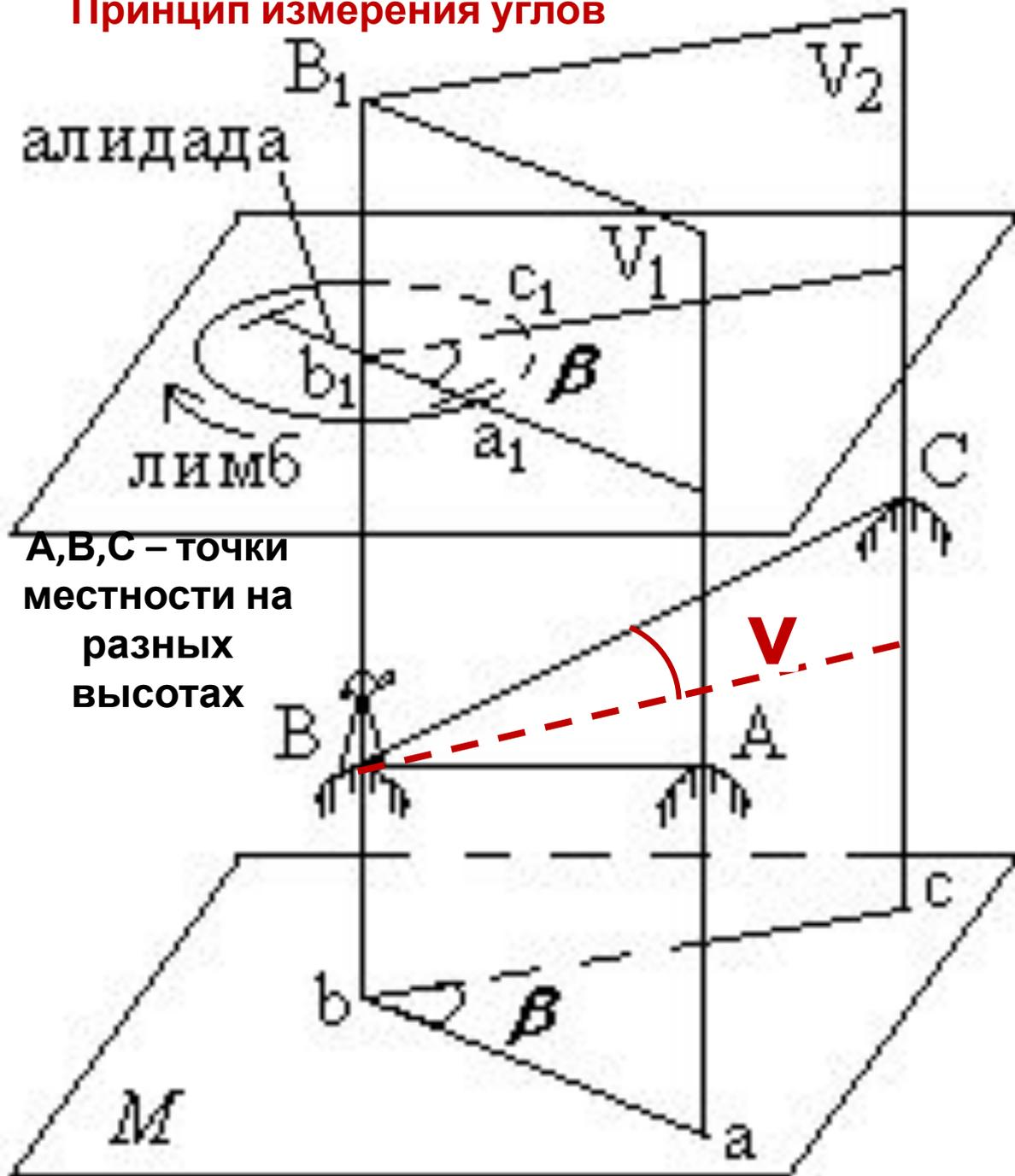
Горизонтальный угол  $\beta$  при вершине В образован проекцией направлений ВА и ВС на горизонтальную плоскость М.
