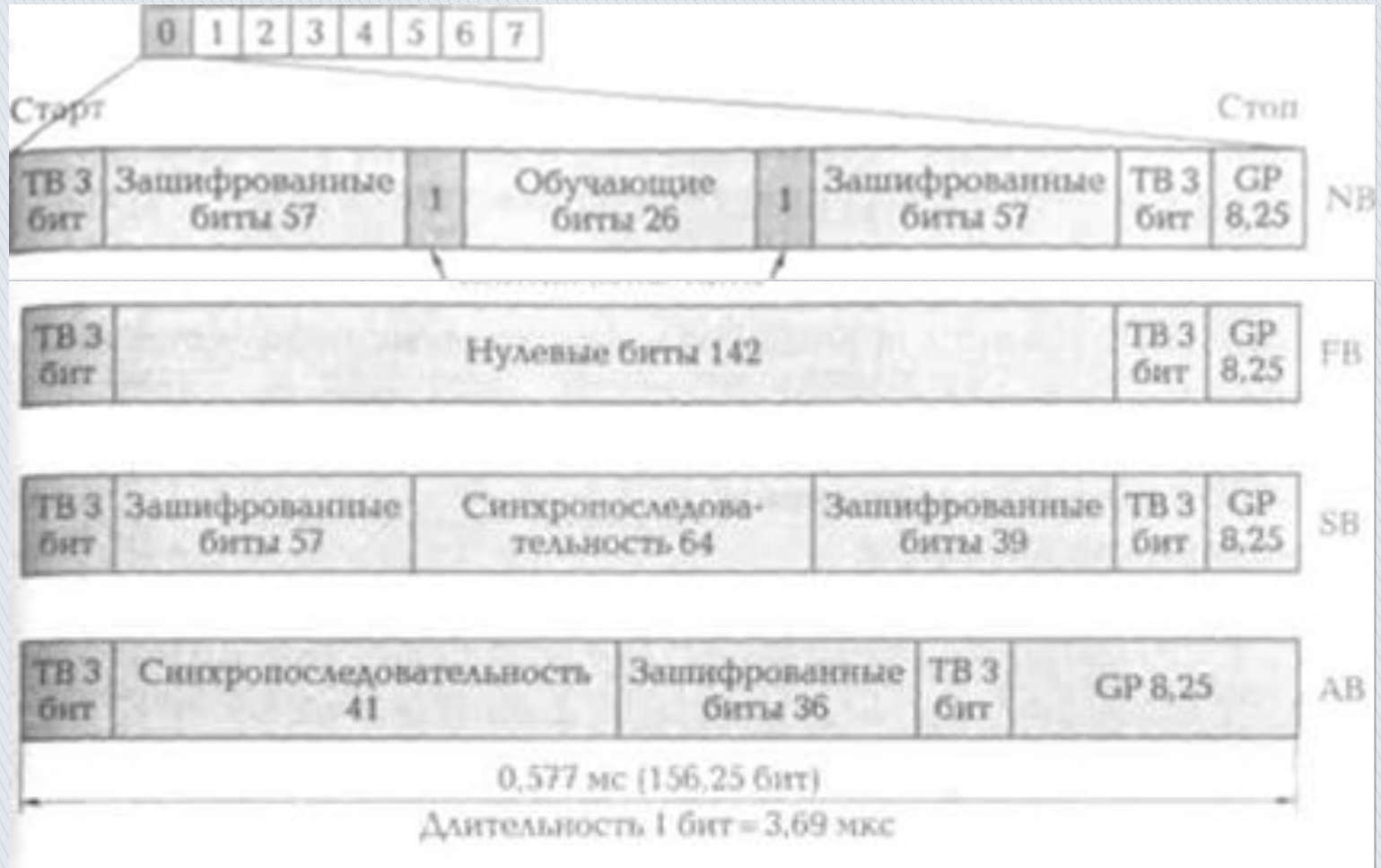
Рис. 3. Структура кадра стандарта GSM
