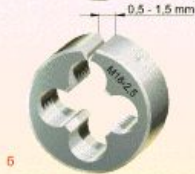
а - плашка цельная, б - плашка разрезная 1 - плашка, 2 - резьба, 3 - заборная часть
