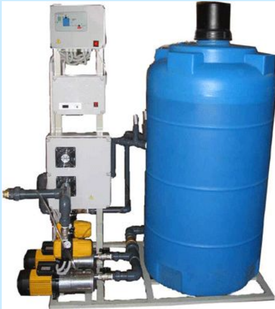
Внешний вид установки для озонирования воды
