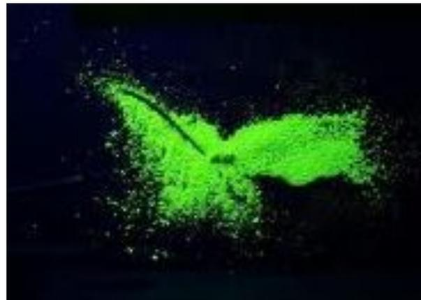
Мощность сигналов зависит от степени волнения и быстро уменьшается с увеличением расстояния. При небольшом волнении на экране РЛС наблюдается множество слабых сигналов, которые меняют свое место и яркость с каждым оборотом антенны. При значительном волнении сигналы от волн сгущены и засвечивают полностью большую часть площади в центре экрана. Современные судовые радиолокационные станции при высоте антенны до 20 м воспринимают сигналы от волн в радиусе до 4 миль.
