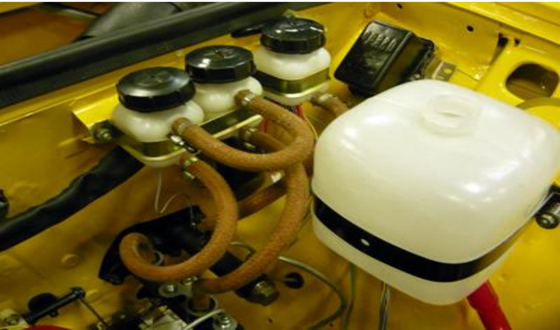
Из главного тормозного цилиндра давление тормозной жидкости передается на рабочие тормозные механизмы колес
