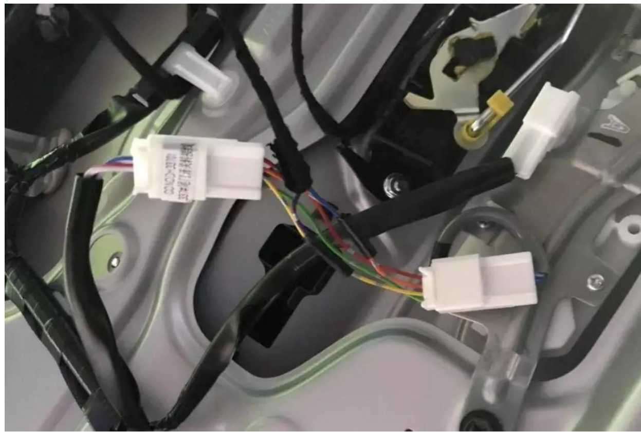
三通转换连接插头与原车插头连接
