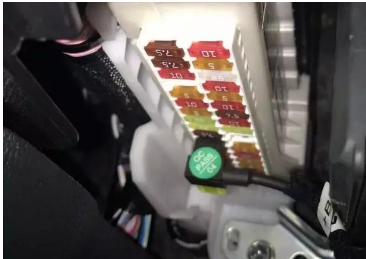
在驾驶位置控制面板下方连接电源
