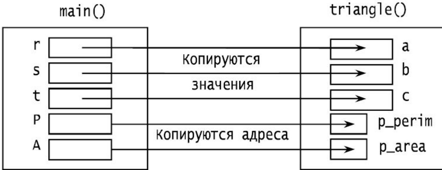
При вызове функции `triangle()` формальные параметры `a`, `b`, `c` получают *значения* фактических аргументов `r`, `s`, `t`. Размеры прямоугольников `p_perim`, `p_area` в два раза меньше, чем размеры прямоугольников `a`, `b`, `c`, так как `a`, `b`, `c` имеют тип `double` размером 8 байт, а указатели `p_perim`, `p_area` имеют размер 4 байта. Формальные параметры `p_perim`, `p_area` получают значения *адресов* внешних переменных `P` и `A`.
