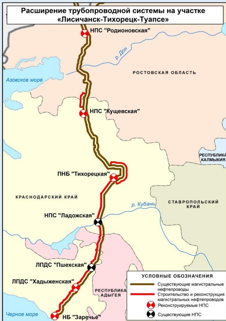
Цель проекта – обеспечение транспортировки нефти на ООО «РН-Туапсинский НПЗ» (ОАО «НК «Роснефть») в количестве до 12 млн тонн в год.
