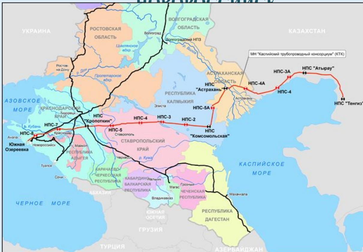
Протяженность трубопроводной системы МН «Каспийский трубопроводный консорциум» (КТК) Тенгиз - Новоросийск составляет 1510 км. Пропускная способность системы КТК увеличена до 67 млн тонн в год (с использованием антифрикционных присадок – до 76 млн тонн в год).
