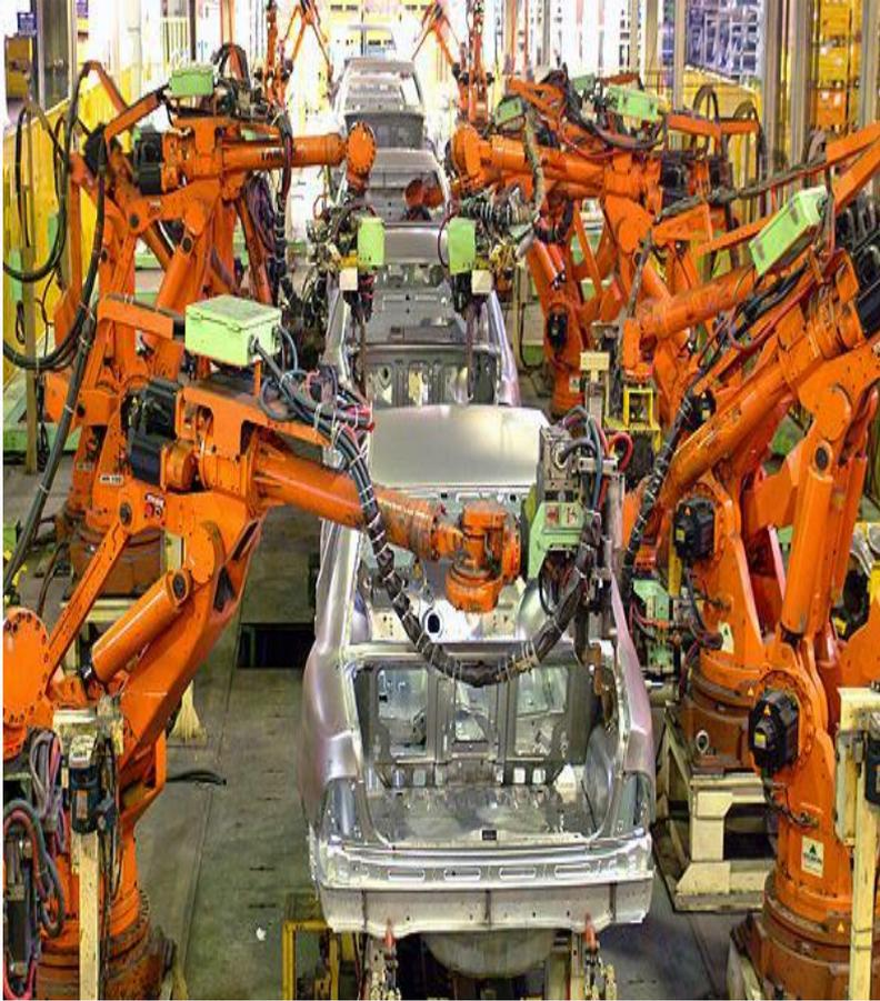
В сборочном конвейере сборка автомобилей разделена между несколькими станциями, вся работа одновременно. Когда одна станция закончена с автомобилем, она передает его на следующее. При наличии трех станций на в общей сложности трех различных автомобилях можно управлять в то же время, каждый на различном этапе его собрания.
