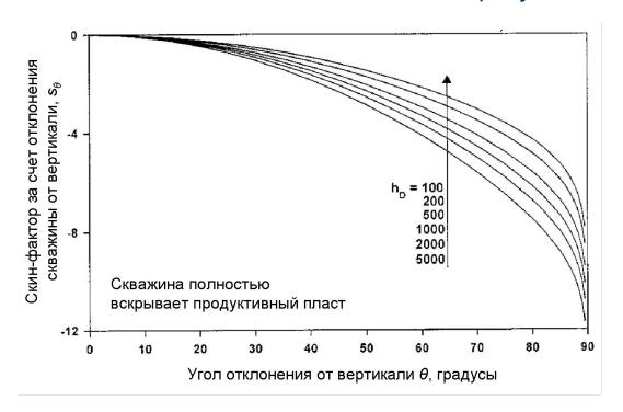
Скин-фактор. Расчет общего скин-фактора для различных типов скважин.
