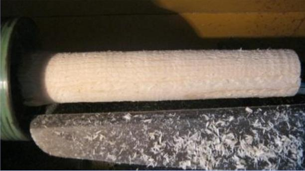
7. Выполнить чистовое точение до диаметра 40 мм.
