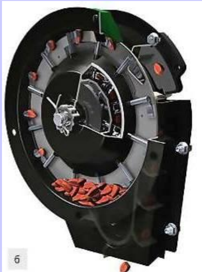
механічно-пальчиковий висівний апарат сівалки KINZE3000 Twin Lene
