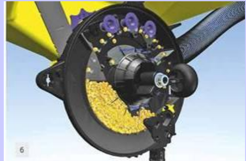
висівний апарат Gilstring Seed Meter сівалки Tempo Väderstad
