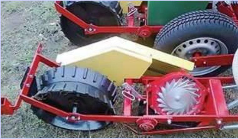
дводисковий механічний висівний апарат сівалки FMR Meprozet
