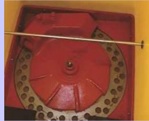
висівний апарат з горизонтальним диском сівалки Gamma UNIA
