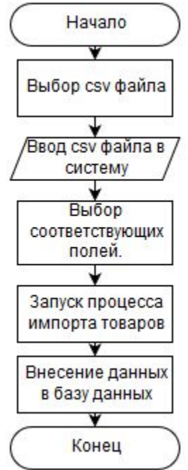
Рис. 4. Блок-схема алгоритма импорта товаров
