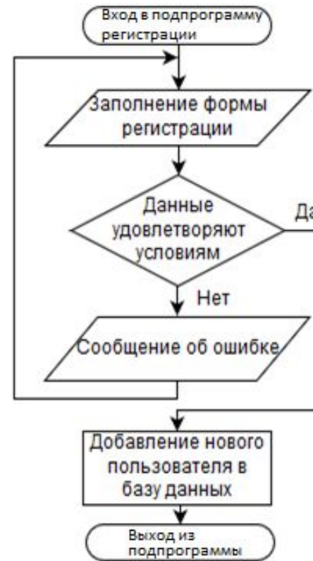
Рис. 2. Блок-схема алгоритма подпрограммы регистрации пользователя
