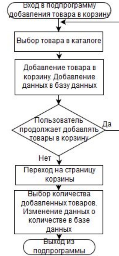
Рис. 3. Блок-схема алгоритма подпрограммы оформления заказа
