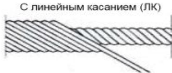
Канаты, работающие на блоках и барабанах с полукруглой канавкой, следует выбирать с прядями ЛК, т.к. их долговечность в 1,5-2 раза больше, чем канатов с прядями ТК.
