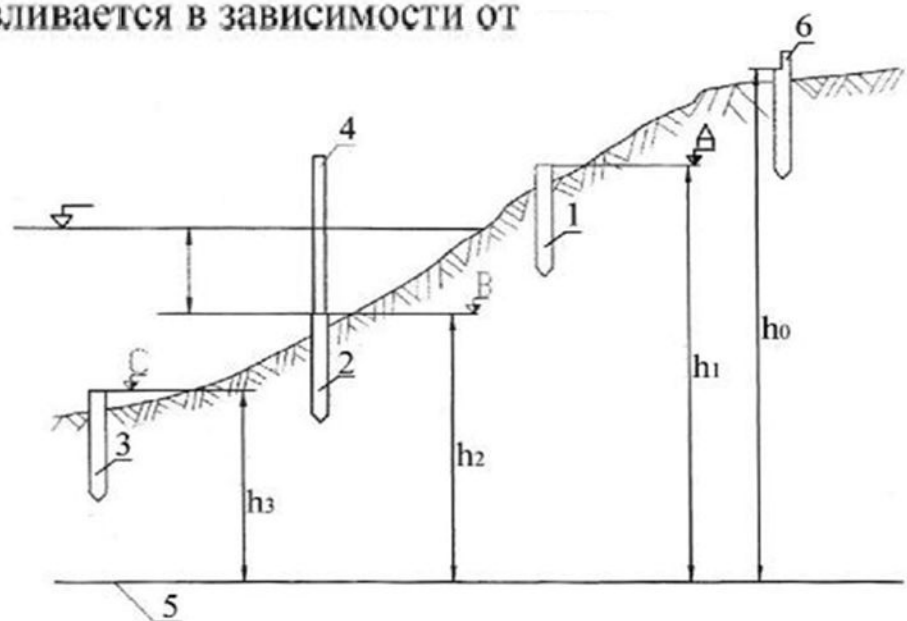
Рис. 2. Схема определения отметок уровня воды на свайном водомерном посту:
