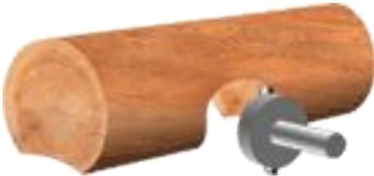
После установки в заданной точке и выставления необходимого угла происходит механический или пневматический прижим и резка поперечного паза (чашки) соответствующего диаметра.
