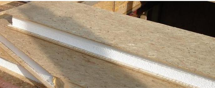
Конструкционная теплоизоляционная панель состоит из двух **ориентированных стружечных плит (ОСП)**, между которыми под давлением приклеивается слой твердого **пенополистирола** в качестве утеплителя. Толщина панелей в готовом виде составляет от 120 мм до 224 мм. Максимальный размер панели 2,4 метра на 7,0 метра. Такая панель обладает исключительными энергосберегающими свойствами и имеет **высокую прочность**.
