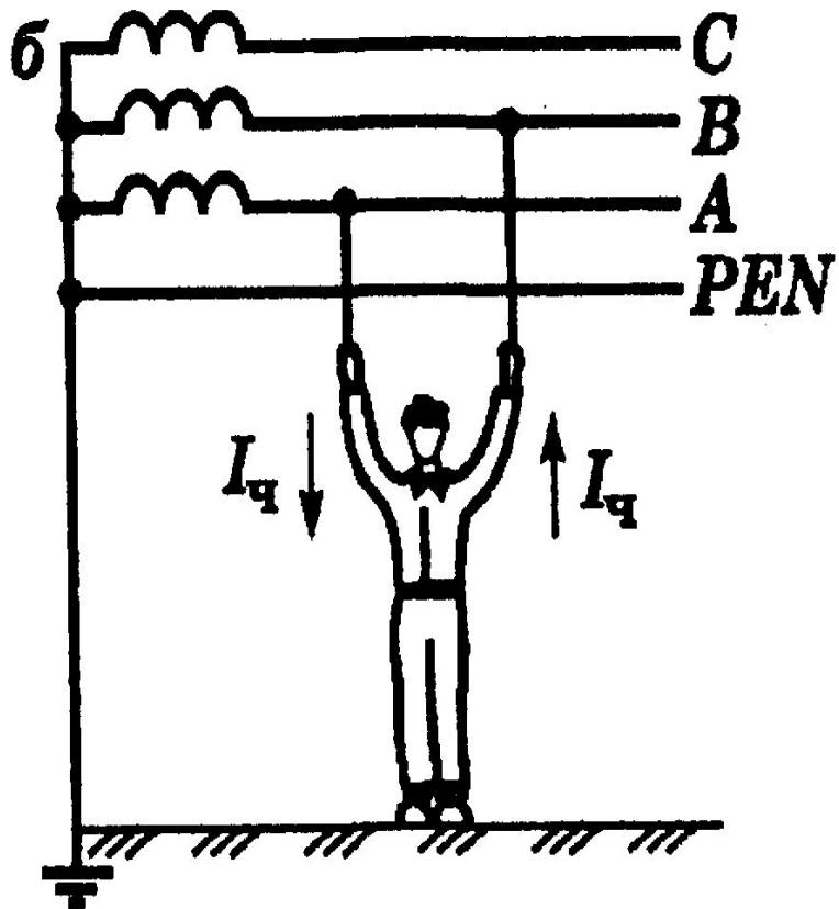
Однофазное прикосновение в сети с заземленной нейтралью
