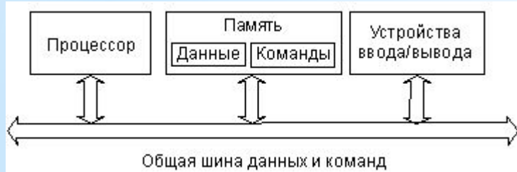
Пристанская архитектура (с общей шиной команд и данных)
