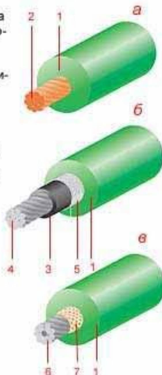
Токопроводящая жила (рис. 2) бывает нескольких типов:
