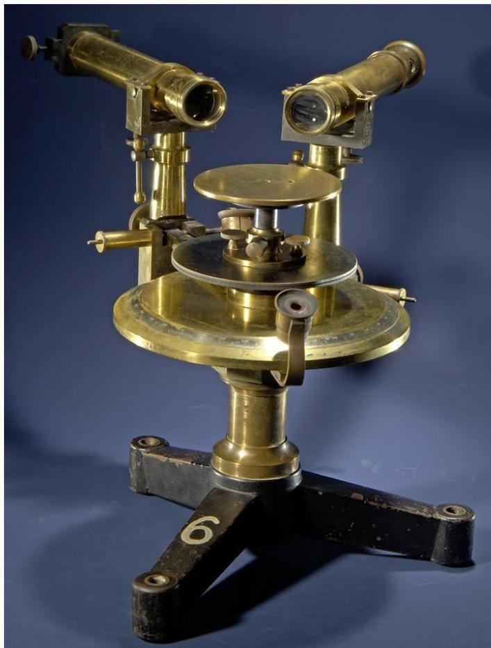
**Спектральные приборы** — это приборы, хорошо разделяющие волны различной длины и не допускающие перекрытия отдельных участков спектра.
