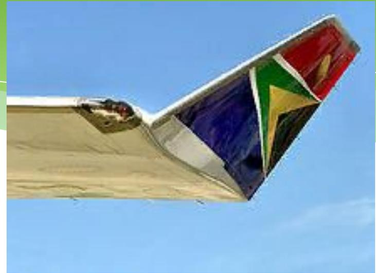
Аэродинамическая законцовка крыла на Boeing 747-400
