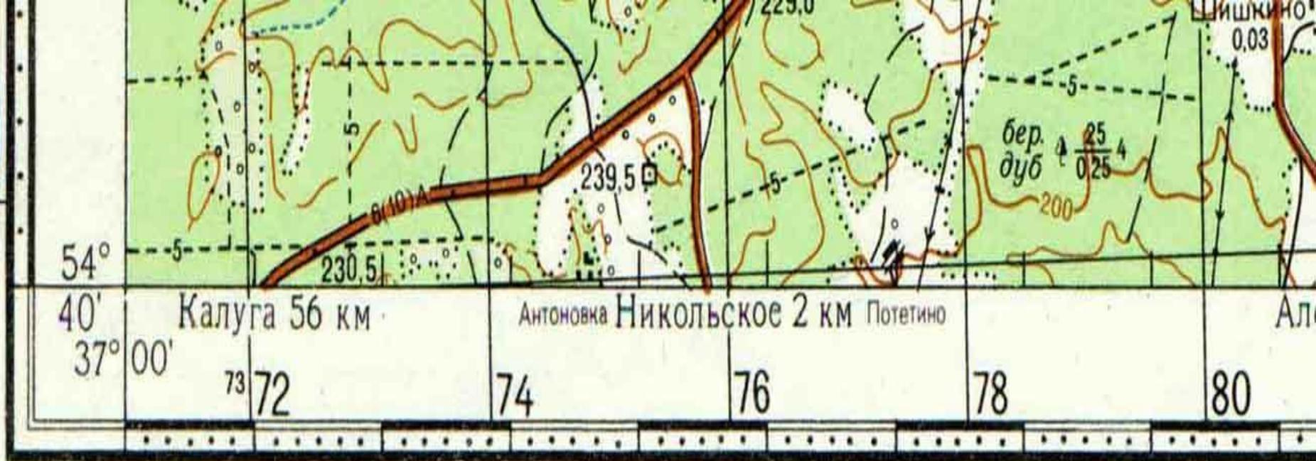
Склонение на 1983 г. восточное  $7^{\circ}38'$  (1-27). Среднее сближение меридианов западное  $1^{\circ}26'$  (0-24). При прикладывании буссоли (компаса) к вертикальным линиям координатной сетки среднее отклонение магнитной стрелки восточное  $9^{\circ}04'$  (1-51). Годовое изменение склонения западное  $0^{\circ}01'$  (0-00). Поправка в дирекционный угол при переходе к магнитному азимуту минус (1-51).
