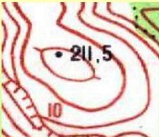
**Абсолютная высота** – высота точки земной поверхности над уровнем Балтийского моря. (от нуля пункта Кронштадского водомерного моста).
