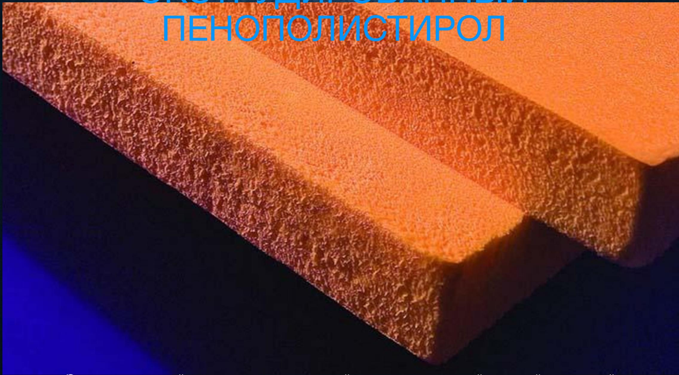
Экструдированный пенополистирол - жесткий материал с закрытой ячеистой структурой, полученный методом экструзии вспенивающегося полистирола или одного из его сополимеров.
