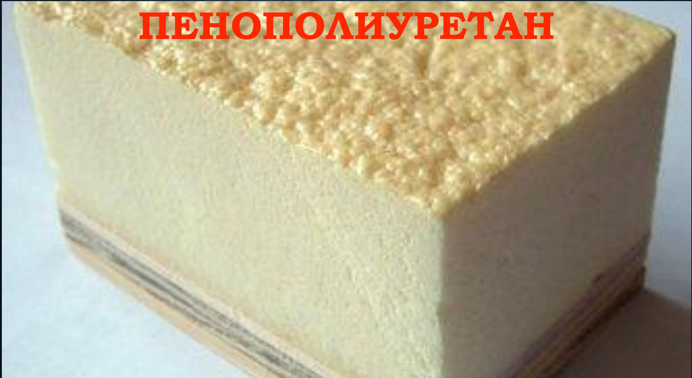
Пенополиуретан - жесткий или полужесткий материал с закрытой ячеистой структурой. Может применяться в виде жестких панелей или жидких смесей. Коэффициент теплопроводности - 0,03-0,04 Вт/(м·К);
