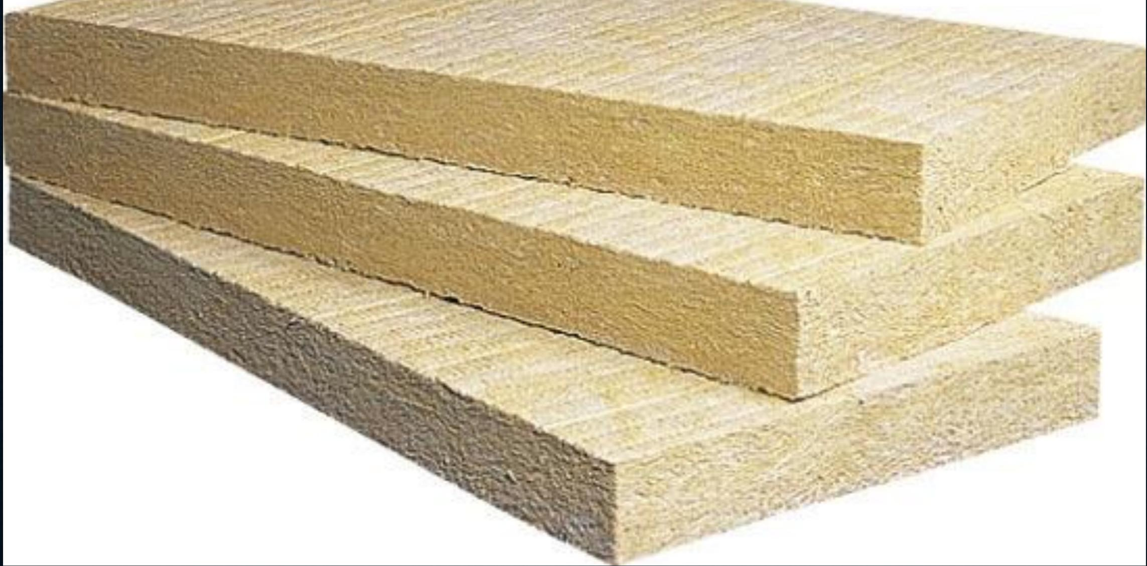
Минеральная вата – волокнистый материал, имеющий структуру ваты и изготовленный из расплава горной породы с добавлением органического связующего компонента.
