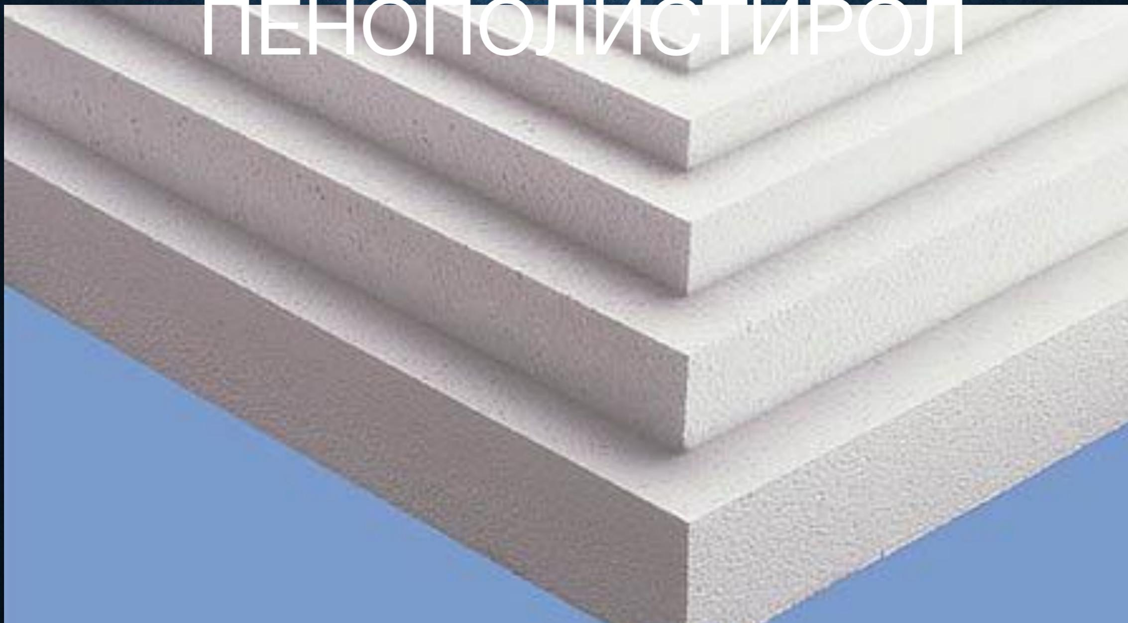
Вспененный пенополистирол – жесткий материал, в основном с ячеистой структурой, полученный путем спекания гранул полистирола или одного из его сополимеров.
