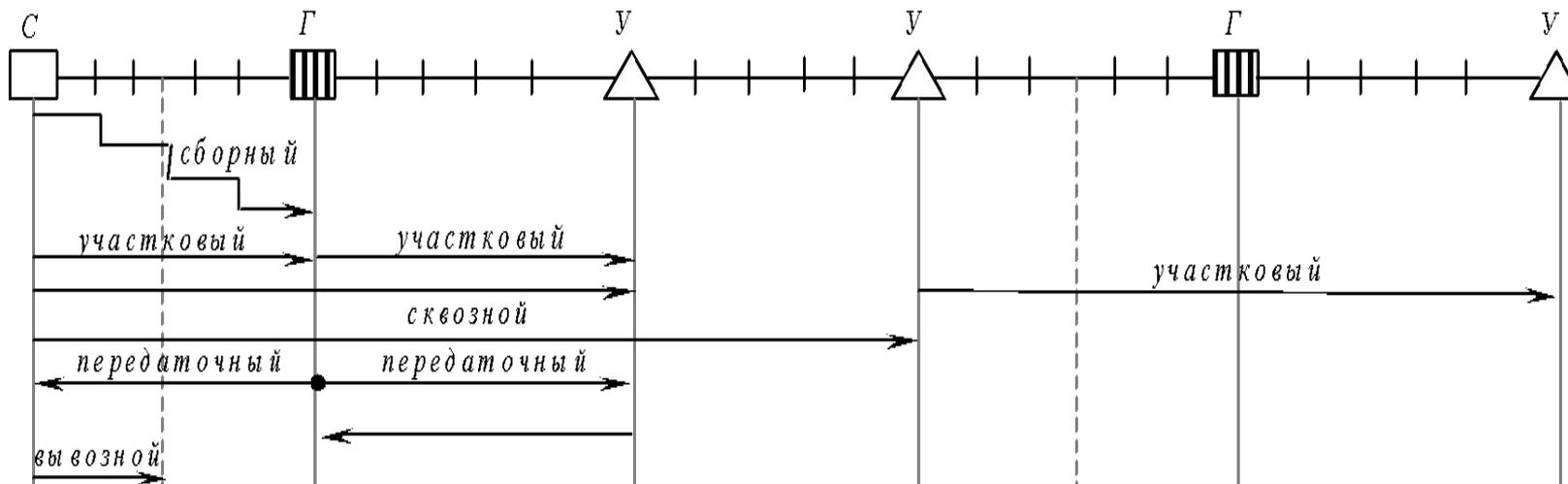
**Сборный поезд** – поезд, который развозит на промежуточные станции, а иногда и на разъезды, вагоны под выгрузку, либо собирает погруженные вагоны с промежуточных станций.
