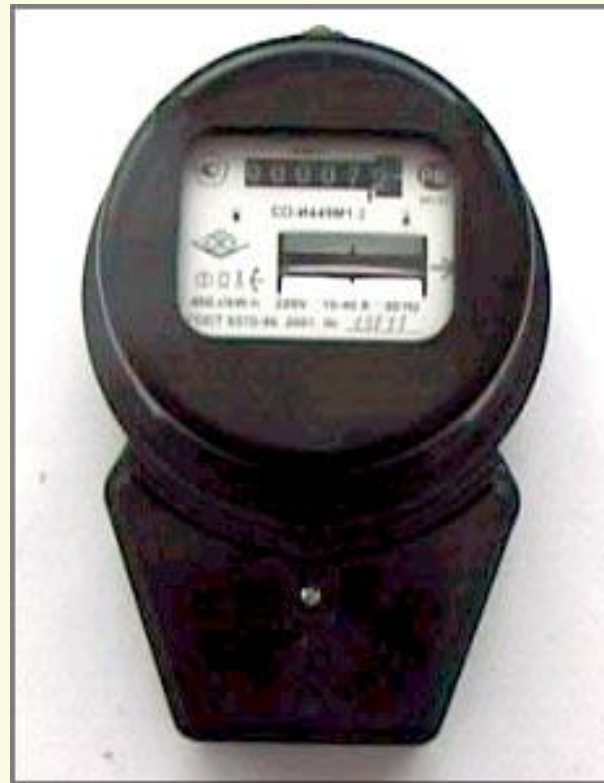
Рис. 18. Внешний вид индукционного однофазного счетчика электроэнергии
