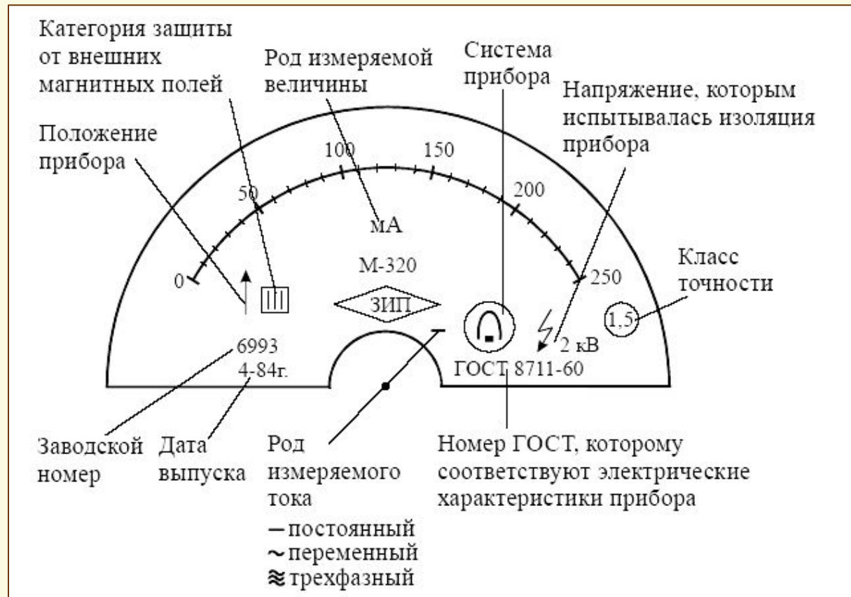
Рис. 1. Лицевая панель аналогового стрелочного прибора непосредственной оценки
