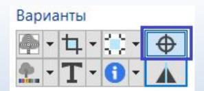
**«Печатать регистрационные метки»** - позволяет напечатать метки для последующей резки фрезером.
