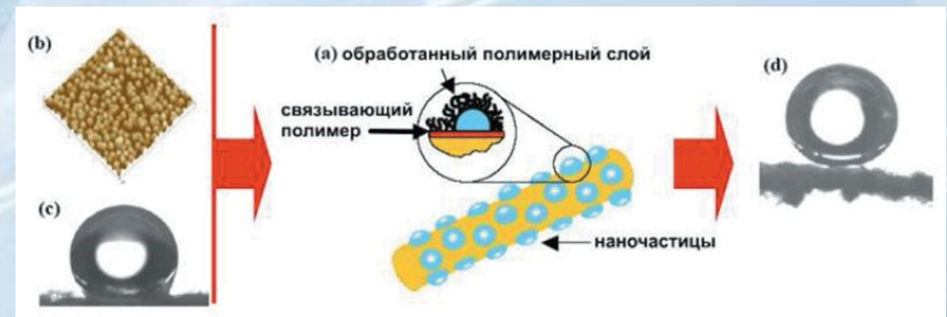
Рис. 7. Схема принципа действия новой ткани
