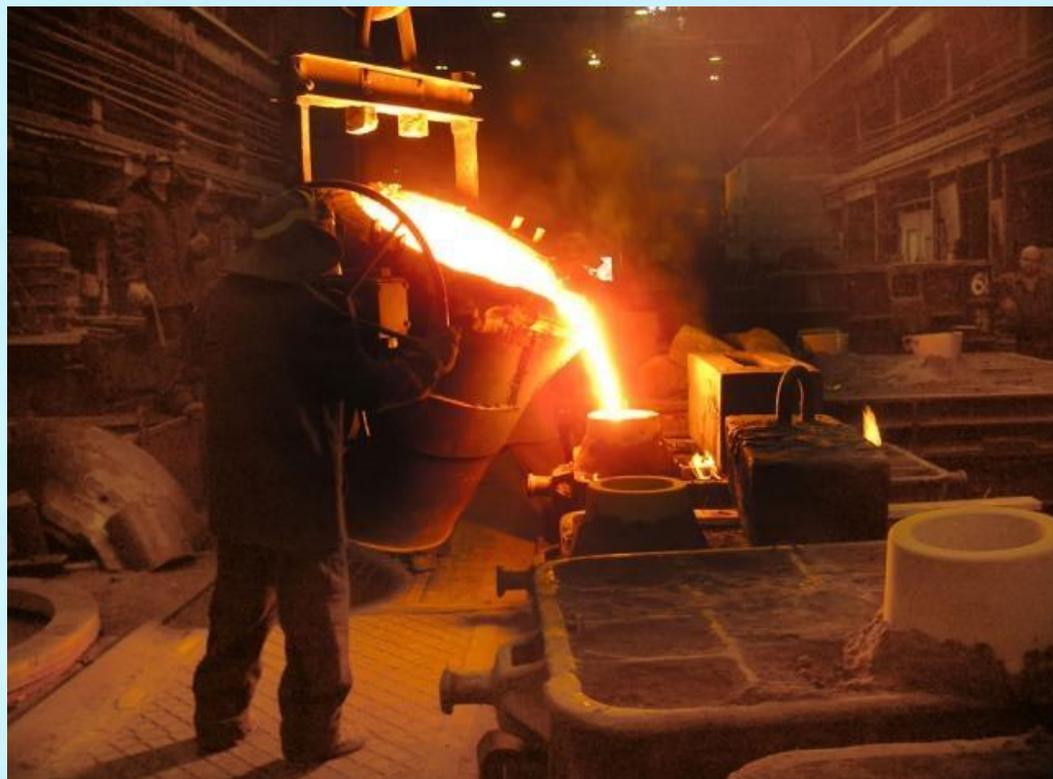
*Розлив металла из индукционной тигельной печи на заводе Уралхиммаш*
