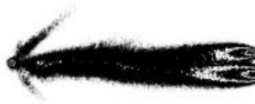
Фотография катодного стримера S=30 \text{ мм} U=42 \text{ кВ} , P=740 \text{ торр}
