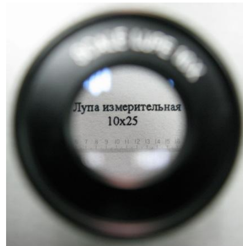
Многоэлементная измерительная лупа - с увеличением 10^{\times} (тип В)
