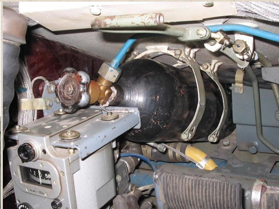
**Манометр** - предназначен для контроля давления воздуха в системе.
