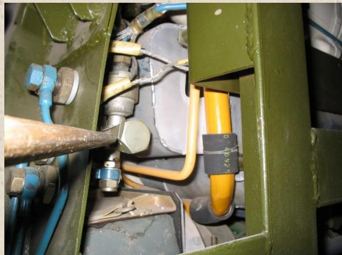
**Электропневмоклапаны ЭК-48** - служат для подачи воздуха из системы к бустеру приводов клапанов нагнетателя и к бустерам устройства подтормаживания.
