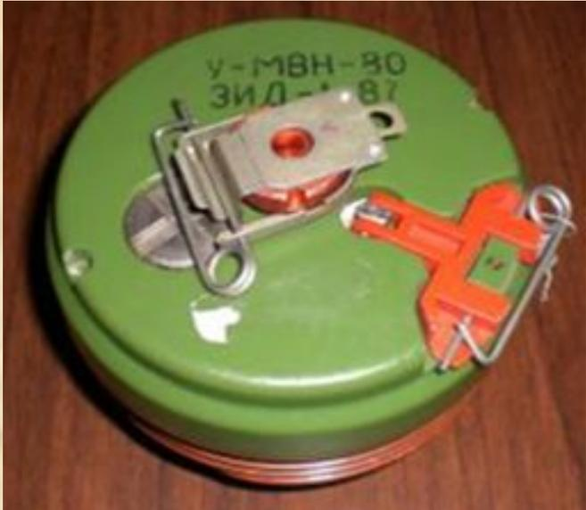
**Взрыватель МВН-80** предназначен для снаряжения противотанковых мин серии ТМ-62 и мин ТМ-72 и обеспечивает их подрыв под всей проекцией движущихся целей.
