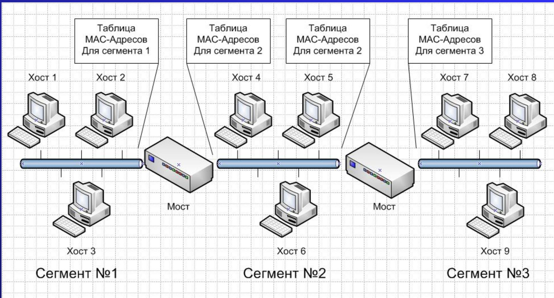
Мосты "изучают" характер расположения сегментов сети путем построения адресных таблиц вида "Интерфейс: MAC-адрес", в которых содержатся адреса всех сетевых устройств и сегментов, необходимых для получения доступа к данному устройству.
