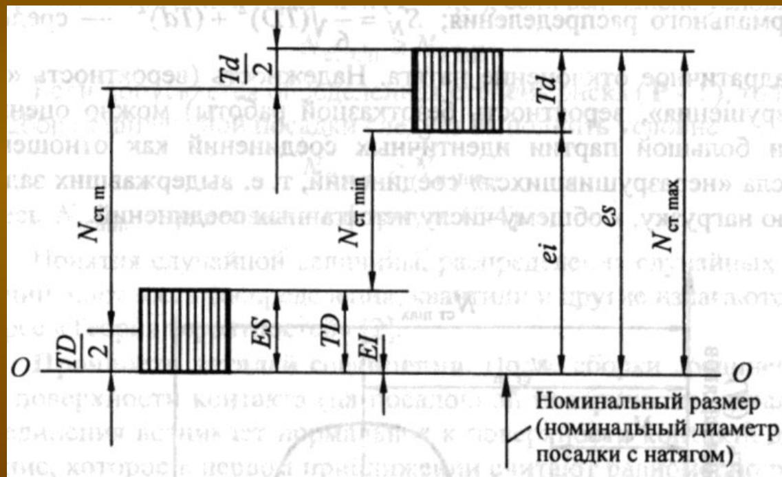
У большой партии одинаковых деталей размер диаметра посадочной поверхности является случайной величиной и имеет рассеивание (распределение), которое в пределах поля допуска близко к нормальному распределению Гаусса. Натяги также подчиняются распределению Гаусса.
