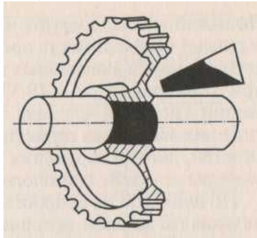
Схема фиксации, стопорения и герметизации подвижных соединений типа «вал-втулка»
