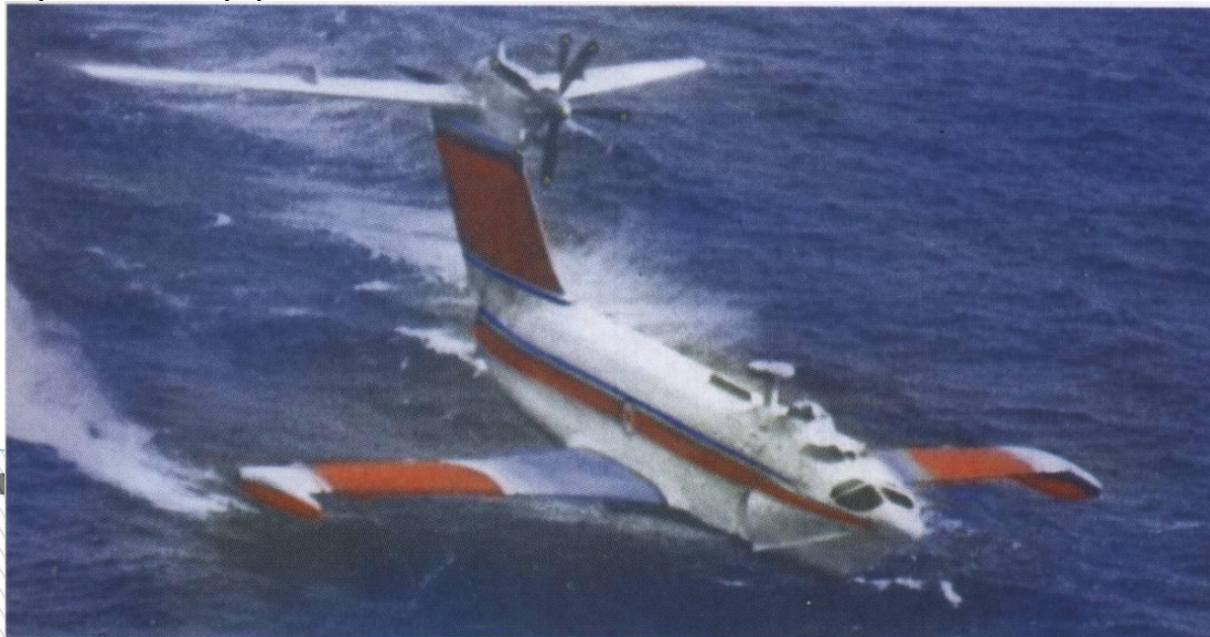
Первый транспортно-десантный экраноплан ВМФ «Орлёнок» конструкции Р.Е. Алексеева
