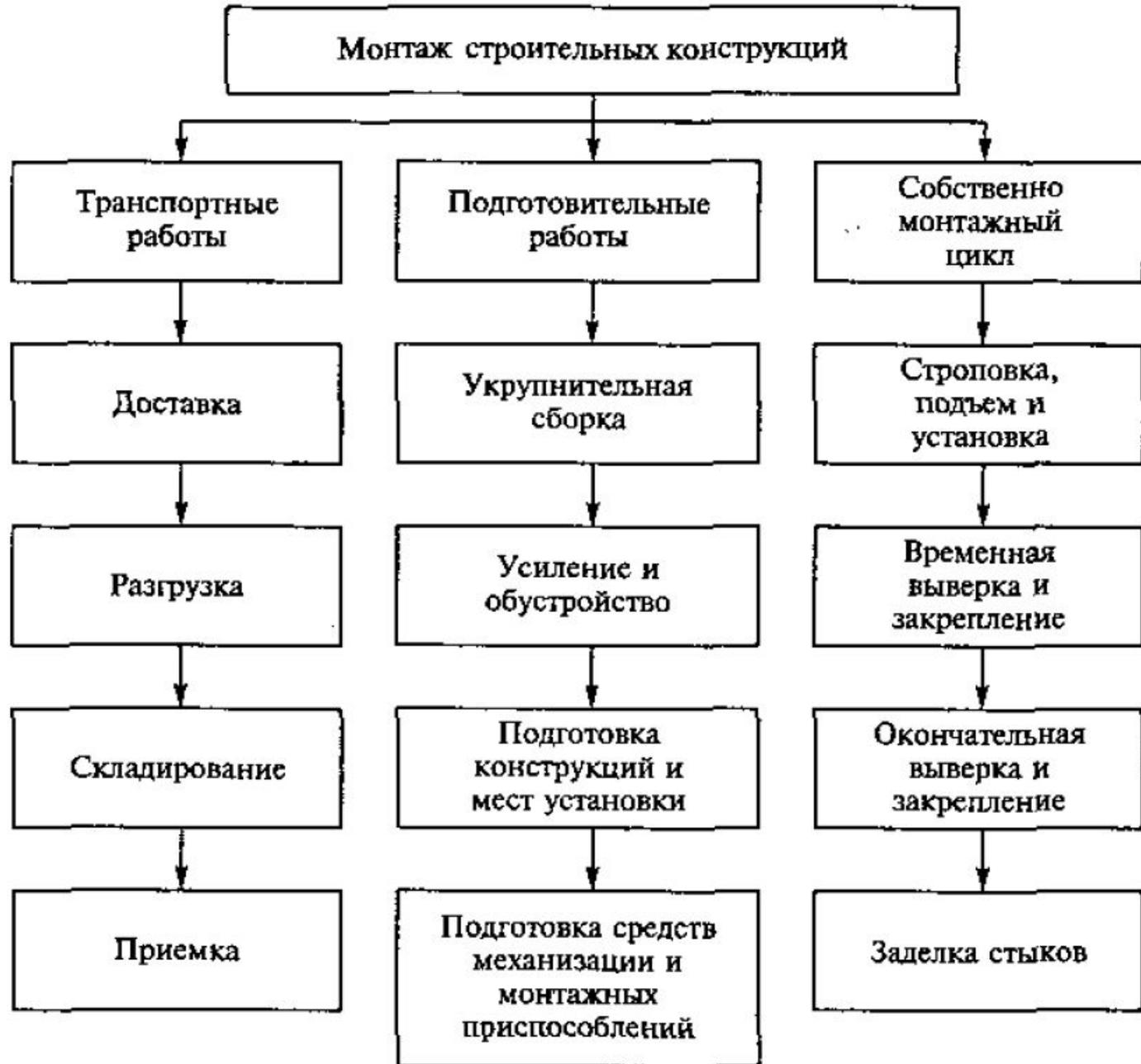
Схема технологического процесса монтажа строительных конструкций
