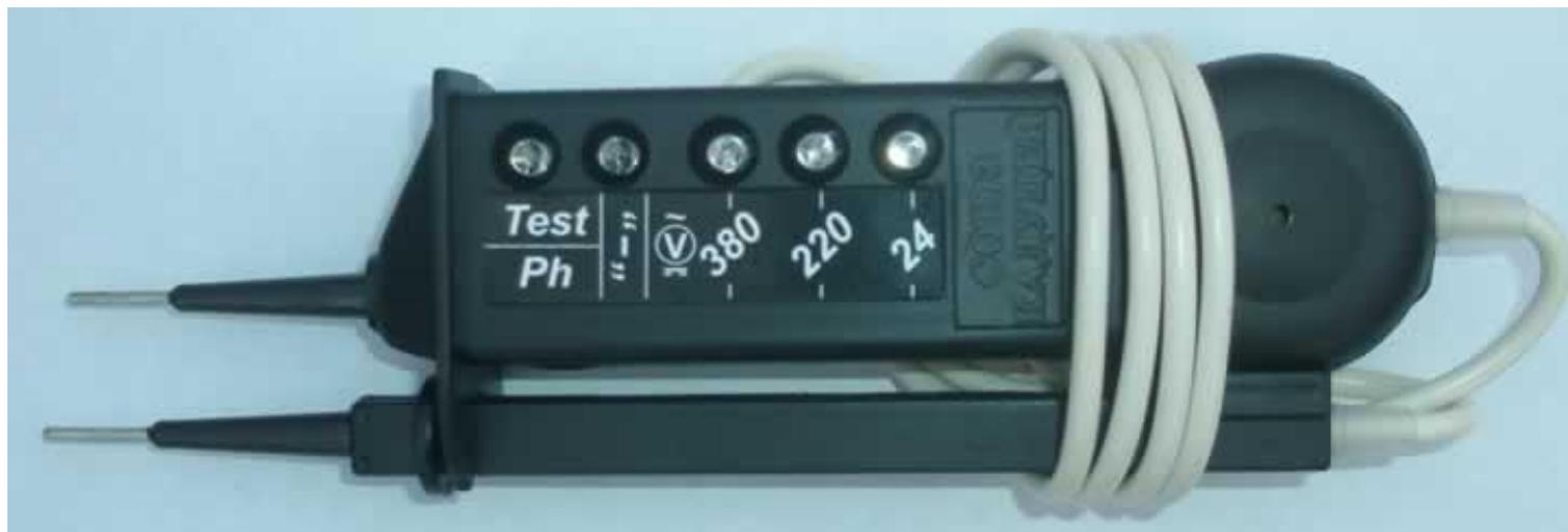
Указатели, предназначенные для электроустановок до 1000 В делятся на двухполюсные и однополюсные.
