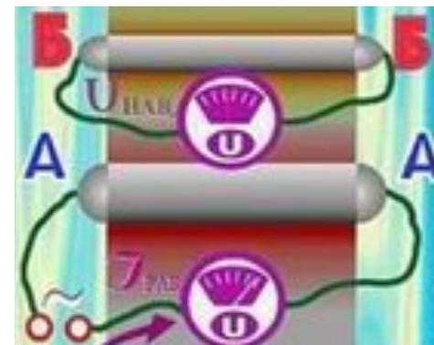
По проводнику А - А протекает переменный рабочий ток ( $I_{\text{раб.}}$ ). Вокруг этого проводника существует электромагнитное поле (окрашено в красный цвет).
