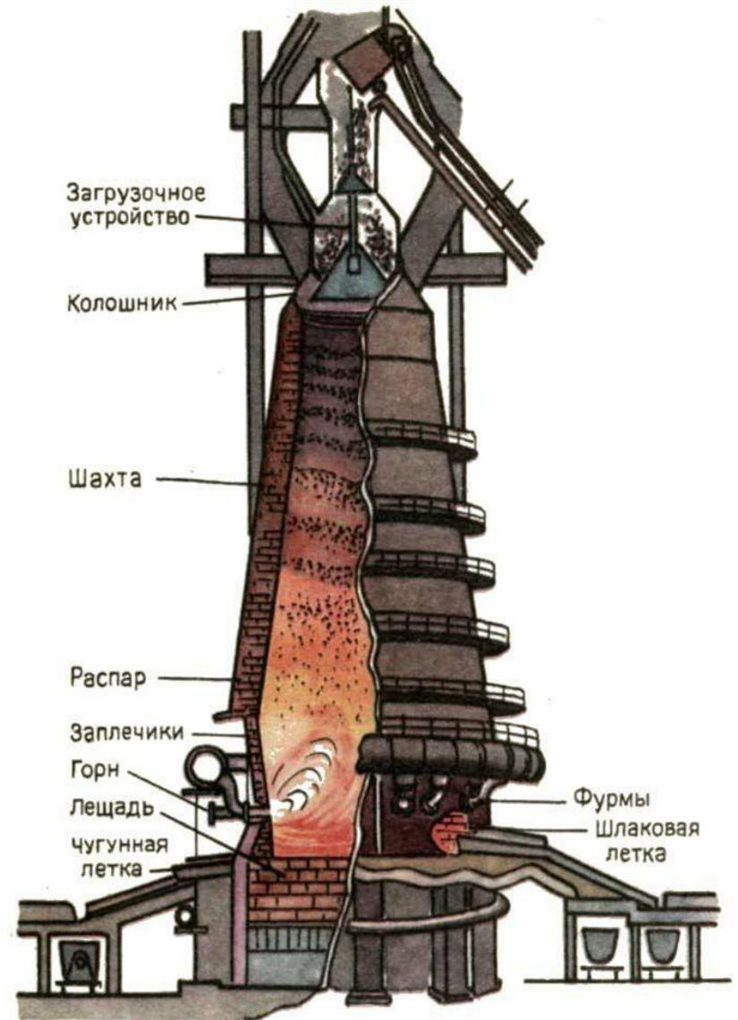
Помимо чугуна, в доменной печи образуется шлак, в который переходят невосстановившиеся оксиды элементов, т.е.  $\text{CaO}$ ,  $\text{MgO}$ ,  $\text{Al}_2\text{O}_3$ ,  $\text{SiO}_2$  и небольшое количество  $\text{MnO}$  и  $\text{FeO}$ , причем  $\text{CaO}$  специально добавляют к железорудной шихте для получения жидкого шлака.
