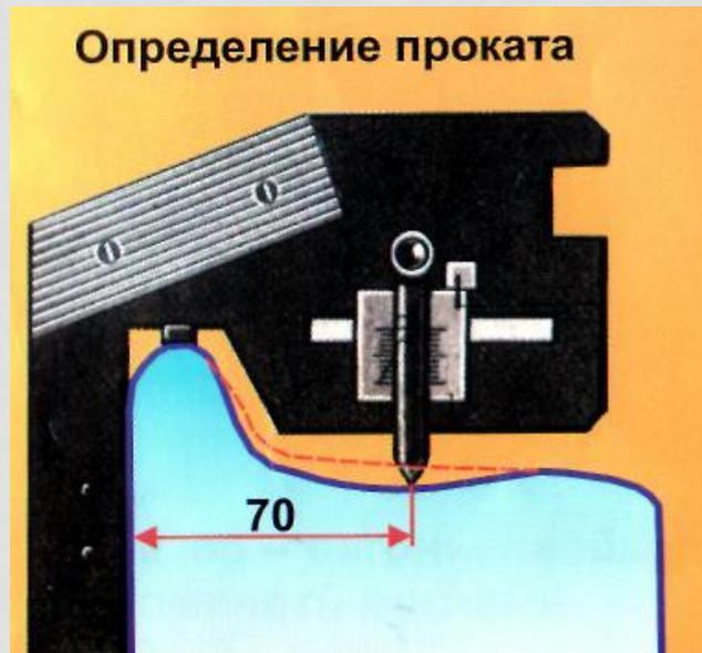
Не допускается выпускать в эксплуатацию и к следованию в поездах железнодорожный подвижной состав, если при скоростях движения **до 120 км/ч** прокат по кругу катания у локомотивов и пассажирских вагонов **в поездах дальнего сообщения – более 7 мм.**
