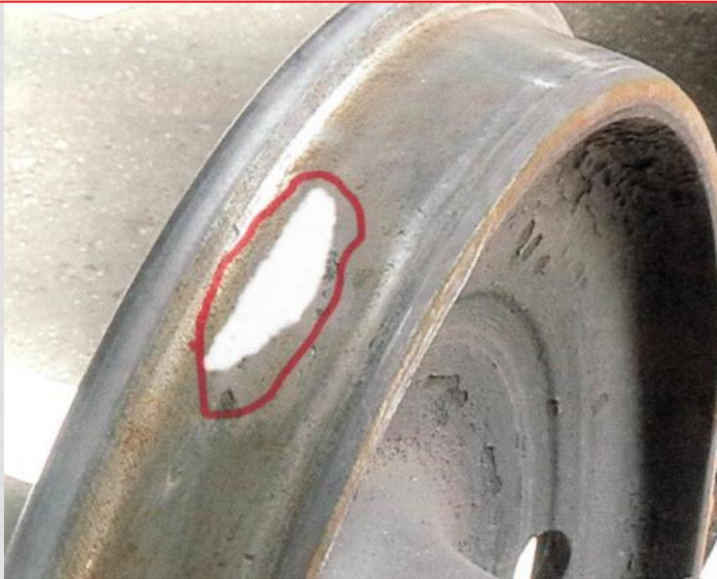
При ползуне на вагоне **свыше 12-ти** мм разрешается следование поезда до ближайшей станции со скоростью 10 км/час при условии вывешивания или исключения возможности вращения неисправной колесной пары.
