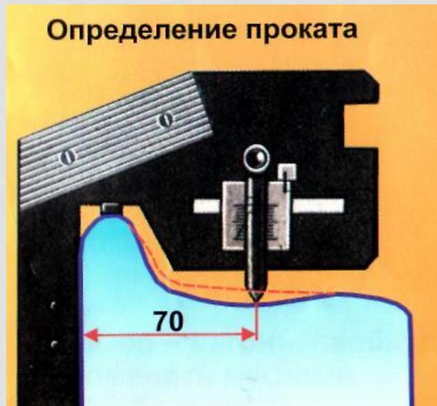
Не допускается выпускать в эксплуатацию и к следованию в поездах железнодорожный подвижной состав, если при скоростях движения **до 120 км/ч** прокат по кругу катания вагонов в поездах местного и пригородного сообщений – **более 8 мм.** У грузовых вагонов - более 9 мм;
