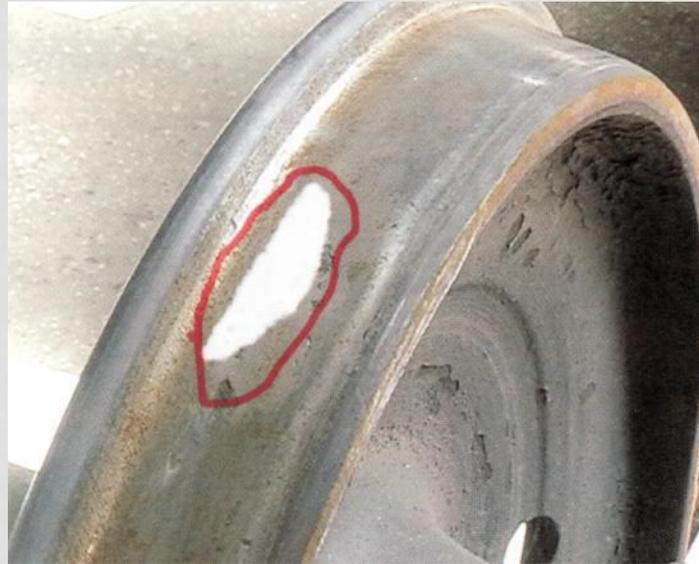
При величине ползуна на вагоне от 2-х **до 6-ти мм** допускается следование поезда **до ближайшей станции** со скоростью 15 км/час, а при величине - **свыше 6-ти** до 12-ти мм – со скоростью 10 км/час, где колесная пара должна быть заменена.
