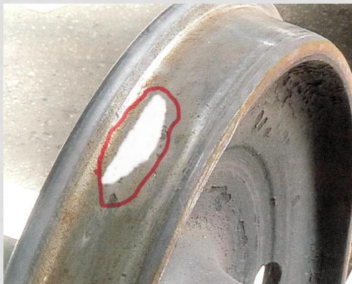
В соответствии с ПТЭ ползун (выбоина) на локомотиве , а также вагоне **не допускается более 1 мм, навар более 0,5 мм.**
