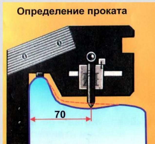
Не допускается выпускать в эксплуатацию и к следованию в поездах железнодорожный подвижной состав, если при скоростях движения свыше 120 км/ч до 140 км/ч прокат по кругу катания у локомотивов, моторвагонного подвижного состава, пассажирских вагонов **более 5 мм.**
