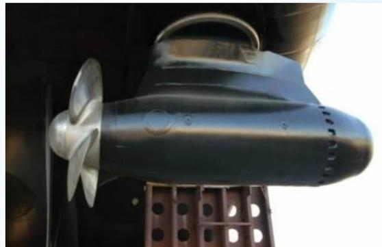
называемые *активные рули, получившие название* рулевая колонка типа *«азипод»* включает в себе небольшой гребной винт с собственным *электрическим мотором.*
