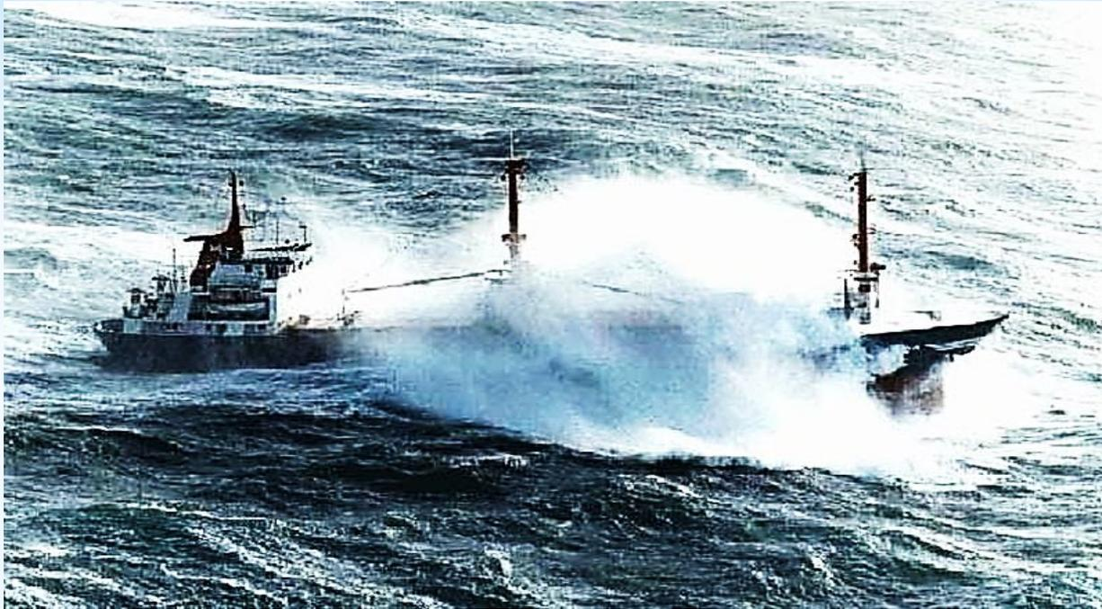
**Качкой судна** называются колебательные движения, совершаемые судном относительно положения равновесия. ***В основном качка возникает под действием гидродинамических сил, обусловленных возмущающим эффектом ветрового волнения.***
