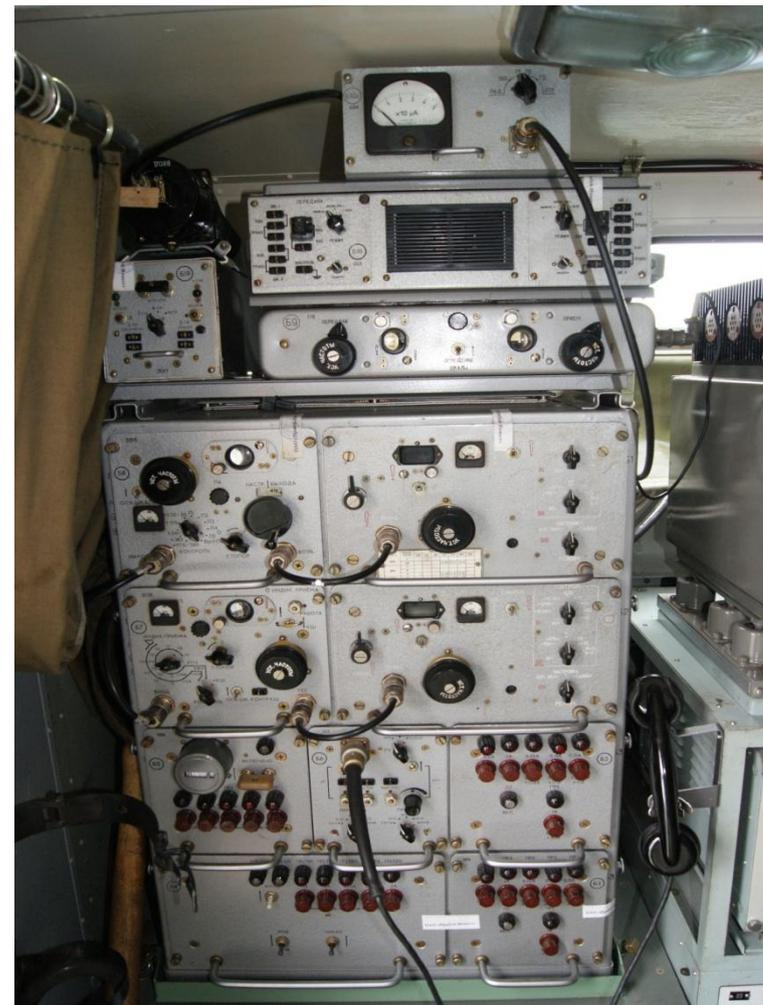
**Аппаратура управления и коммутации** обеспечивает распределение, коммутацию телефонных и телеграфных каналов ко входам возбуждителей «ЛАЗУРЬ», к выходам на линейный ввод для подключения внешних передатчиков и к аппаратуре телеуправления, телесигнализации передатчиков в адаптивном и неадаптивном режимах
