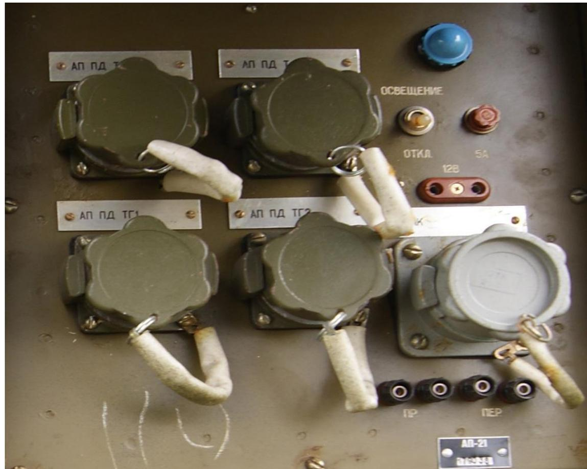
**Аппаратура служебной связи** обеспечивает служебную ГГС и телефонную связь (МТ) радиопередающему узлу Р-161У с приемной аппаратной Р-161ПУ и с внешними передатчиками, подключенными к узлу. Эта аппаратура состоит из блока служебно-диспетчерской связи АР-420 и пульта связи с кабиной АР-411, который, кроме того, обеспечивает управление радиостанцией Р-105М
