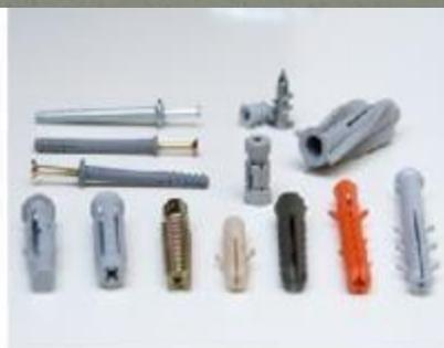
В полученное отверстие забивают **дюбель** — пластмассовую пробку, имеющую отверстие и ребристую поверхность, можно также использовать деревянную пробку, диаметр которой на 1...2 мм больше диаметра отверстия, а длина равна глубине отверстия.
