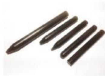
**Рис. 75.** Инструменты для пробивания отверстий в кирпичной или бетонной стене:
