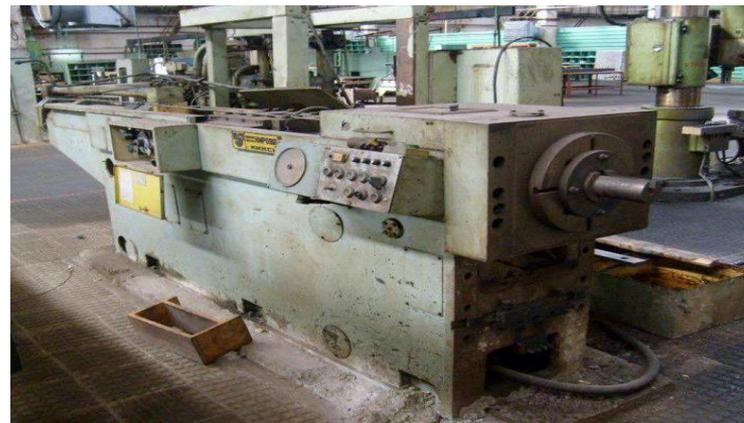
4). Зубофрезерный станок 5E32.
