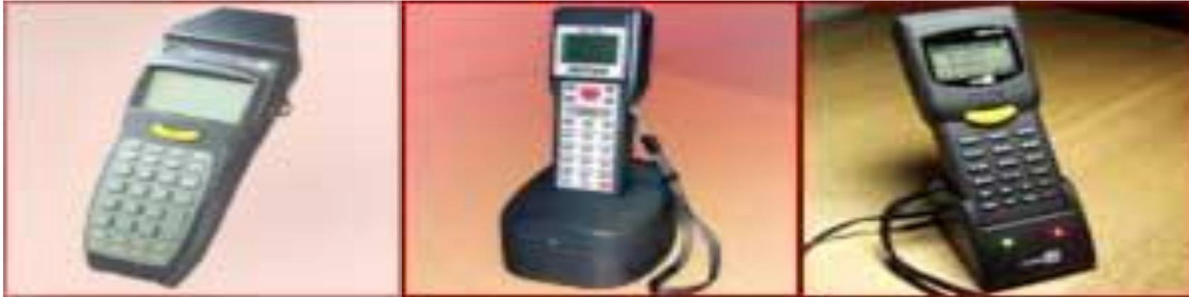
Снабженные сканером штрихового кода, мобильные терминалы сбора данных. Он может облегчить и ускорить работу официанта в ресторане (прием заказов), продавца в зале торговли по образцам при оформлении покупки, кладовщика в процессе отпуска или оприходования товаров.
